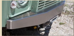
Die Abenteuer4x4-Windenstoßstange ist aus Edelstahl gefertigt, im Finish perfekt gebürstet und besonders stabil. Zusätzliche Einlagen aus eloxiertem Aluminium mit Noppen sorgen für einen rutschfesten Stand. Kaum sichtbar und gut geschützt: die WARN-Seilwinde aus der Zeon-Serie mit elektrischer Freilaufschaltung.
