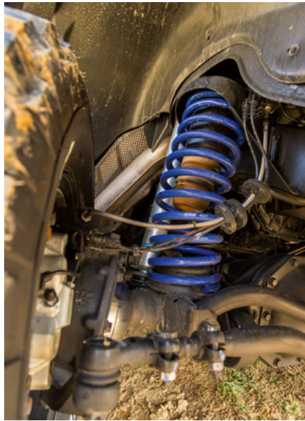
Höher: Das ORC-Fahrwerk hebt den Mercedes G um 40 Millimeter in die Höhe. Jetzt passen auch die größeren Reifen in die Radhäuser.
